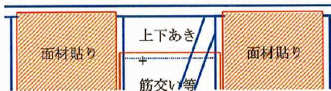
3) A R S 工法：柱接合部補強材料。柱金物の『と』同等の耐力がある。既存コンクリート基礎と柱材の緊結に効果あり。
